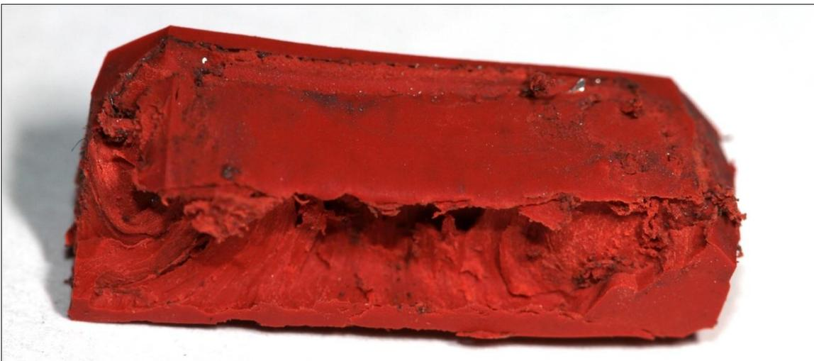
FIGURE 54: 30A SILICON RUBBER SAMPLE AFTER ONE IMPACT
