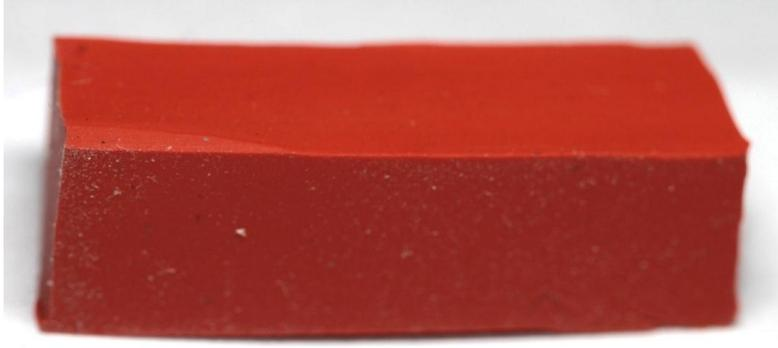
FIGURE 24: NEW 60A SILICON RUBBER SAMPLE
