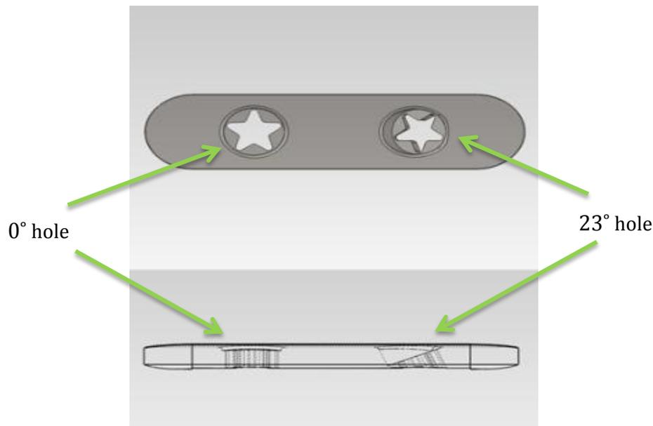
**Figure 8-1: Angled-Hole Bone Plate Design**
