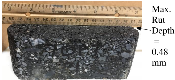
(ii) After Dry Run, 7±1% AV
