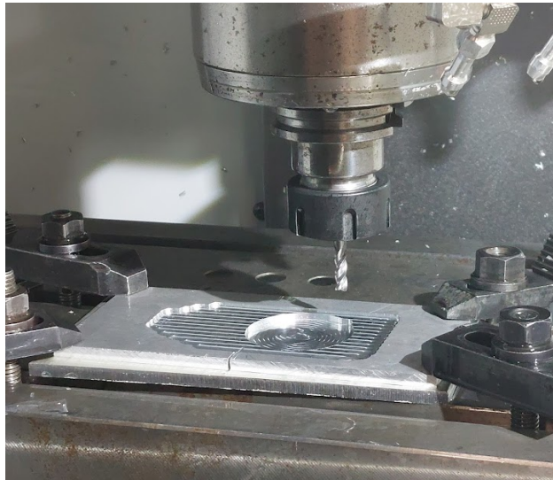
Figure 29. Aluminum Plate in the Haas Super Mini Mill 2.
